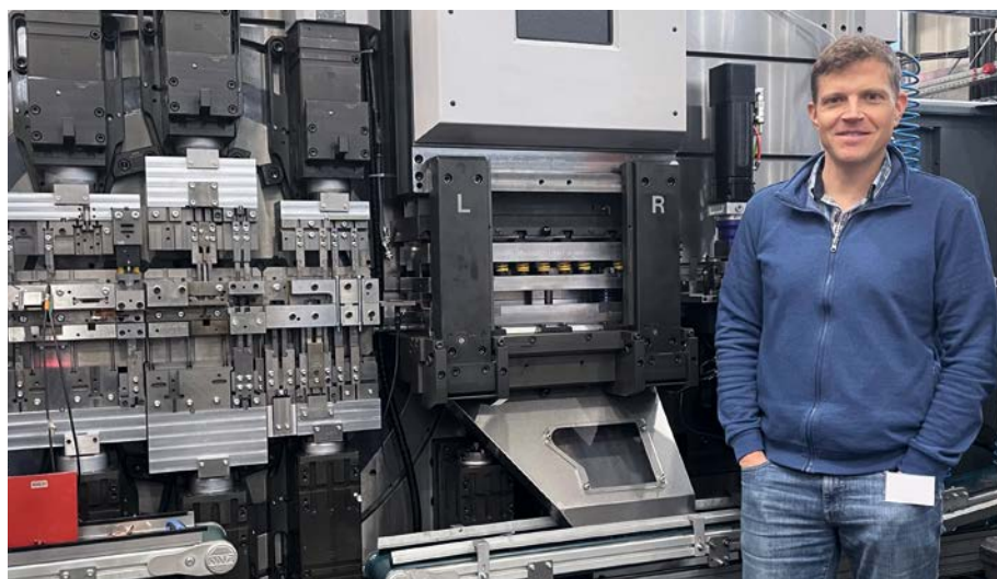
Stephan Meister vor der Stanzmaschine, die den Federkontakt in einem Schritt herstellt.
